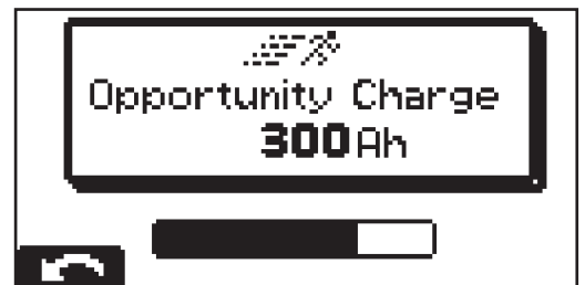
Anzeige bei Start der Zwischenladung
