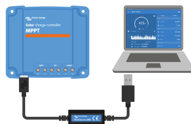
Verbindung der VictronConnect App über USB mit einer VE.Direct USB-Schnittstelle
